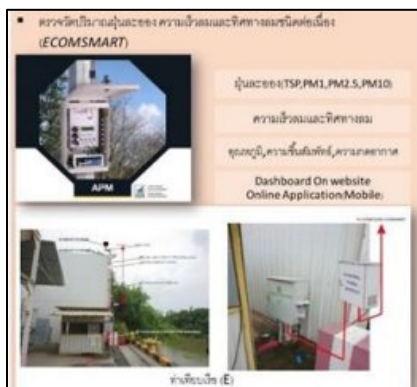
รูปที่ 2-23 เครื่องมือติดตามตรวจสอบคุณภาพอากาศความเร็วลมและทิศทางลมอัตโนมัติ
