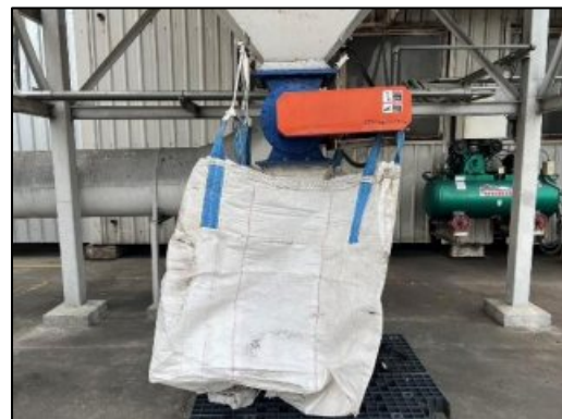
รูปที่ 2-14 ถังกรองดักจับฝุ่น (Bag Filter)
